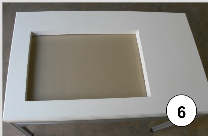
Hier die fertige Platte nach der Entformung. In die Aussparung soll später ein Kochfeld eingebaut werden.
